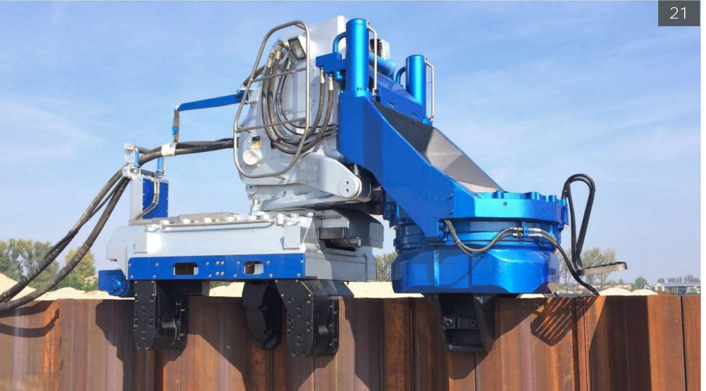
metodă permite inserția de palplanșe în situații de neimaginat în trecut pentru proiectanți din cauza vibrațiilor, aproape de structuri sensibile, sub poduri și viaducte, tuneluri, linii de cale ferată, săpături arheologice, reamenajări, în centre urbane, etc. Un alt avantaj al acestei metode este dimensiunea redusă a acestui utilaj. Folosind această metodă se poate lucra oriunde, deoarece are
